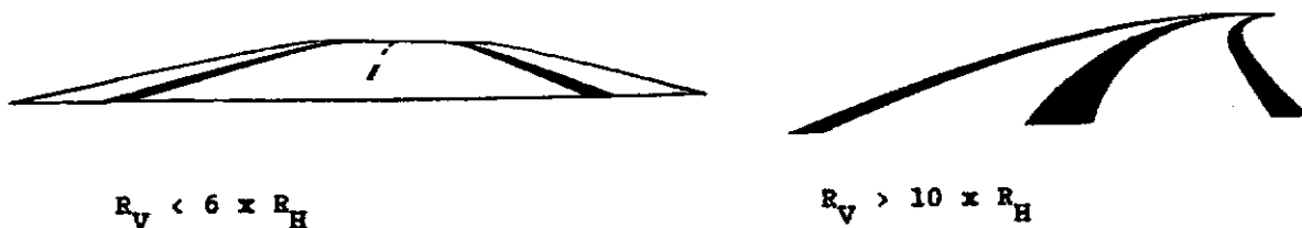
Fig. 8. Til venstre: for lille vertikalradius "skærer vejen af". Til højre: tilstrækkelig stor vertikalradius giver det korrekte vejbillede.
