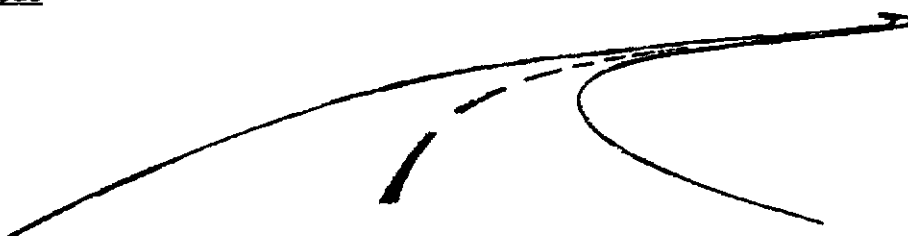
Fig. 12. Længdeprofilet i fig. 11 er her ændret med et bedre optisk vejforløb til følge.
