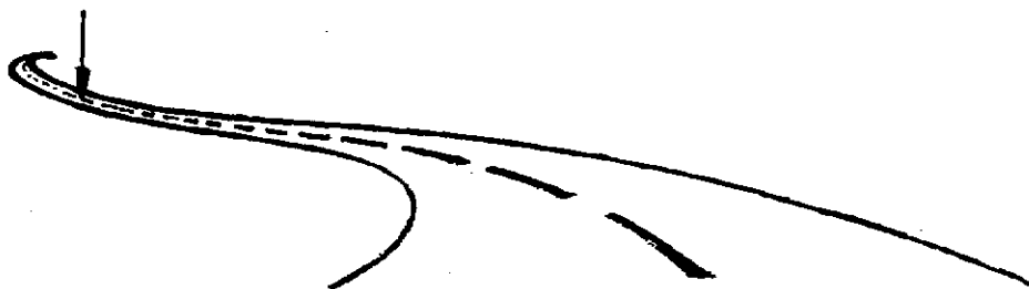
Fig. 10. Stor konkav R_V over vendeklotoide. Den modkrumning, der i vej billedet så småt opstår hen imod den første klotoides slutning (pilen) glider fint over i den begyndende, modsat rettede krumning af den anden klotoide. I vej billedet ser man vendepunktet som liggende før det virkelige vendepunkt (som altså ligger ved pilen).
