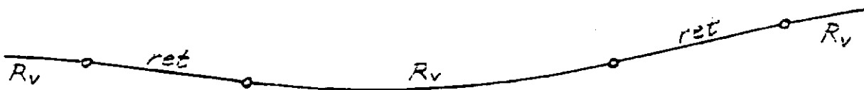
Fig. 14. En lang konkav vertikalkurve giver et godt vejbillede på en retlinet strækning. Bemærk, at længdeprofilet hen over klotoiderne er retlinet, hvilket sikrer, at man ser vejen dreje inden horisonten, - sammenlign. fig. 16.
